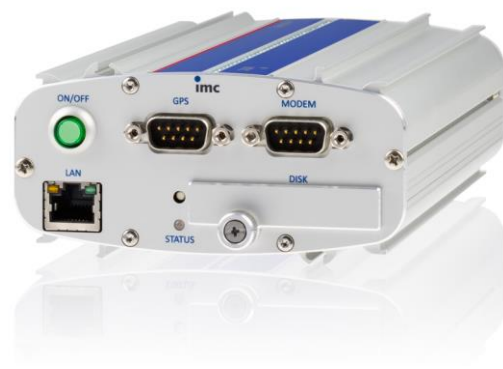
Robust und kompakt: Datenlogger imc BUSDAQ2
