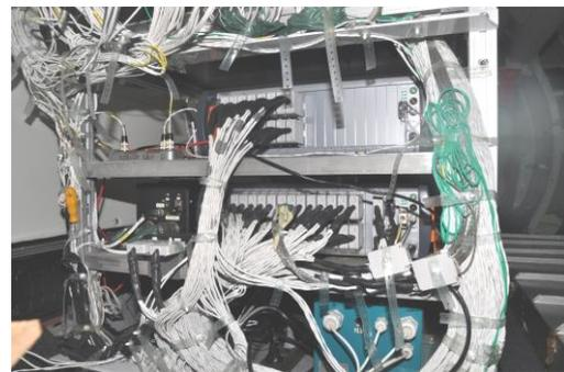
Die Austauschbarkeit der Verstärker der imc CRONOScompact-Geräte ist für den Kunden wichtig, damit er unterschiedlichste Messungen flexibel durchführen kann. Die Messgeräte sind fest im Flugzeug eingebaut und die Sensoren sind über kundenspezifische Anschlusspanel (eigene Steckertypen) verbunden.
