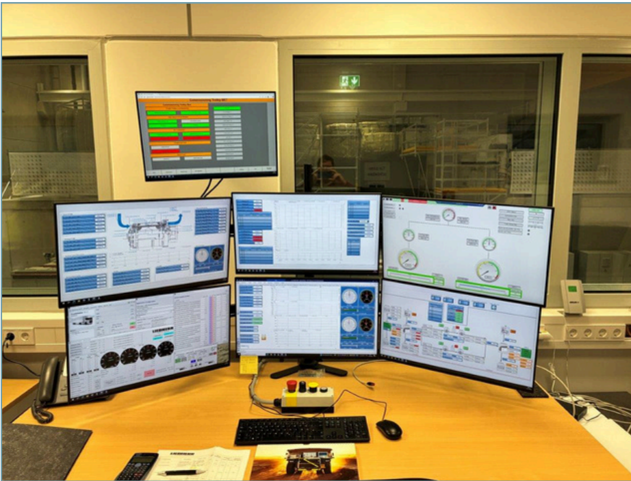
Abb 3. Der Blick in Messwarte - Prüfstandssteuerung mit imc STUDIO.
