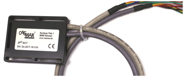
Signalkonditionierung und Sende-Einheit (SCT) in einem IP67 Gehäuse
