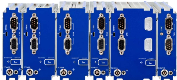
Rückseite des Blocks: CAN, Versorgung, Terminator, Verriegelungsschieber
