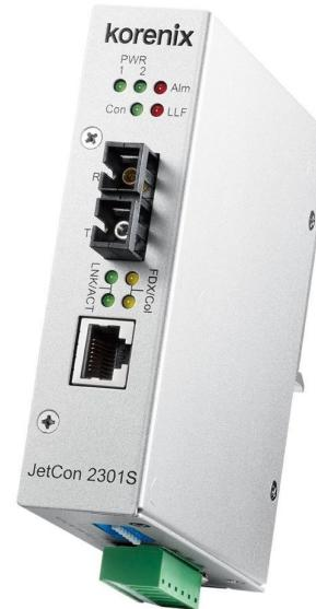
Glasfaserverbindung als Erweiterung des imc CRONOS/flexSystembusses (EtherCAT)
