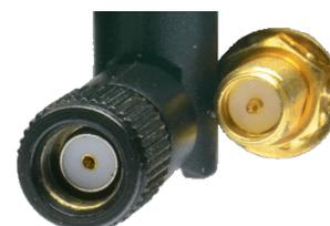
WLAN mit RP-SMA Anschluss:
