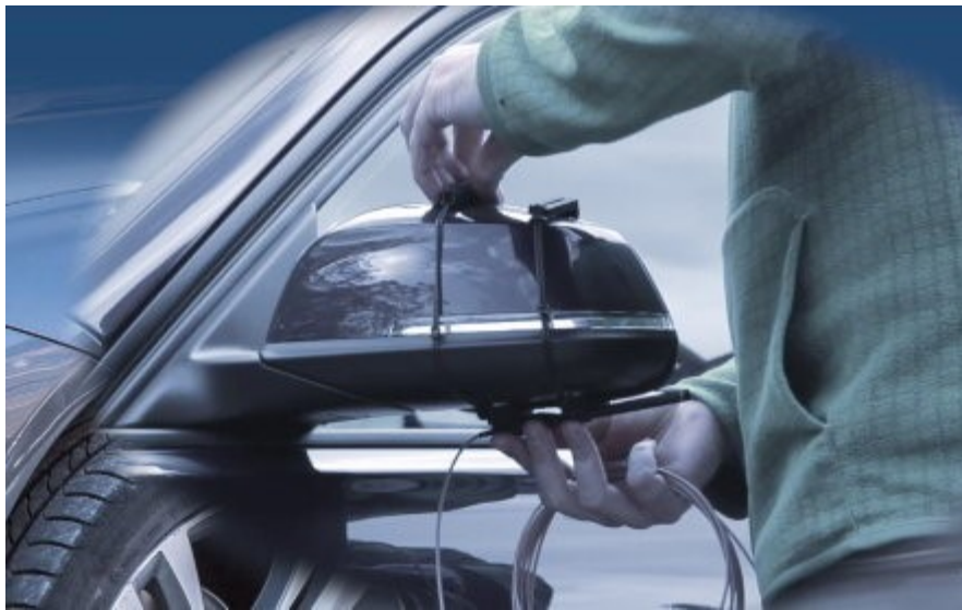
Abb. 11: Anbringen der Spiegelantennen
