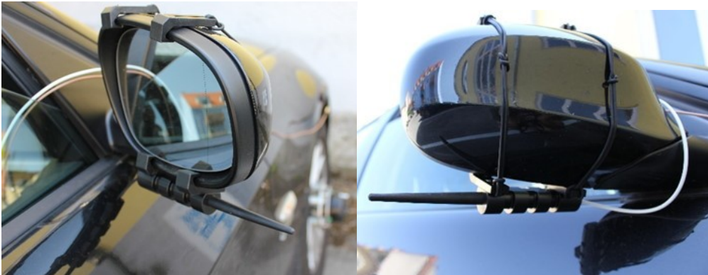
Abb. 28: Spiegelantennen am Spiegel (Vorderseite und Rückseite)
