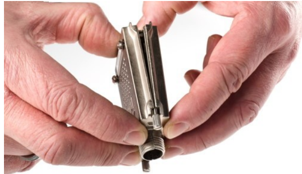
ACC/DSUBM-xxx: Deckel in einem kleinen Winkel ansetzen
