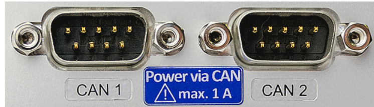
Die Anschlüsse werden entsprechend beschriftet.
