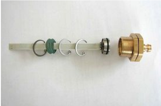
Drucksensor mit integrierter TEDS Erkennungselektronik
