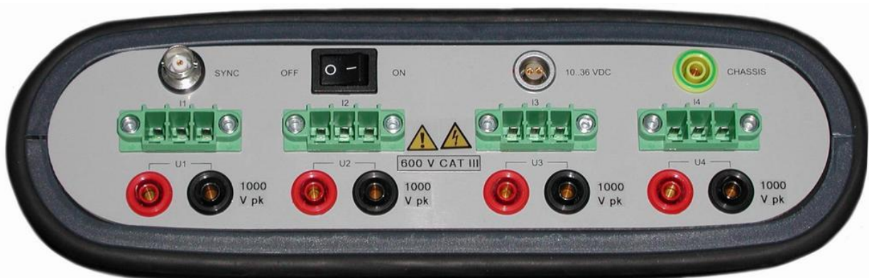
imc POLARES: Anschlussseite der Signale
