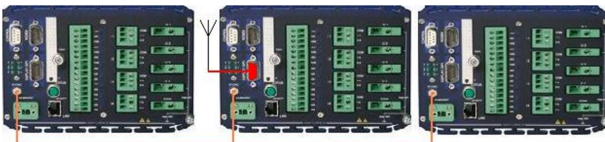
GPS synchronisiertes Mastergerät und Slave Geräten
