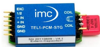
Mit externem Kondensator für verschiedene Durchmesser! 220 nF für Wellendurchmesser 10–400 mm 100 nF für Wellendurchmesser 400–800 mm 68 nF für Wellendurchmesser 800–1200 mm Bei Bestellung angeben!
