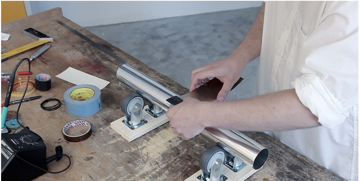
Abb. 31: Zweite Mu-Metall-Schicht anbringen
