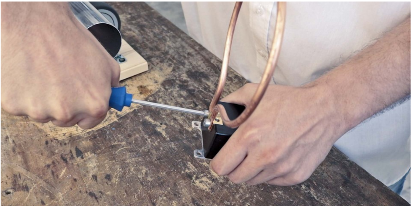
Abb. 52: Primärwicklung am Ringstator festschrauben
