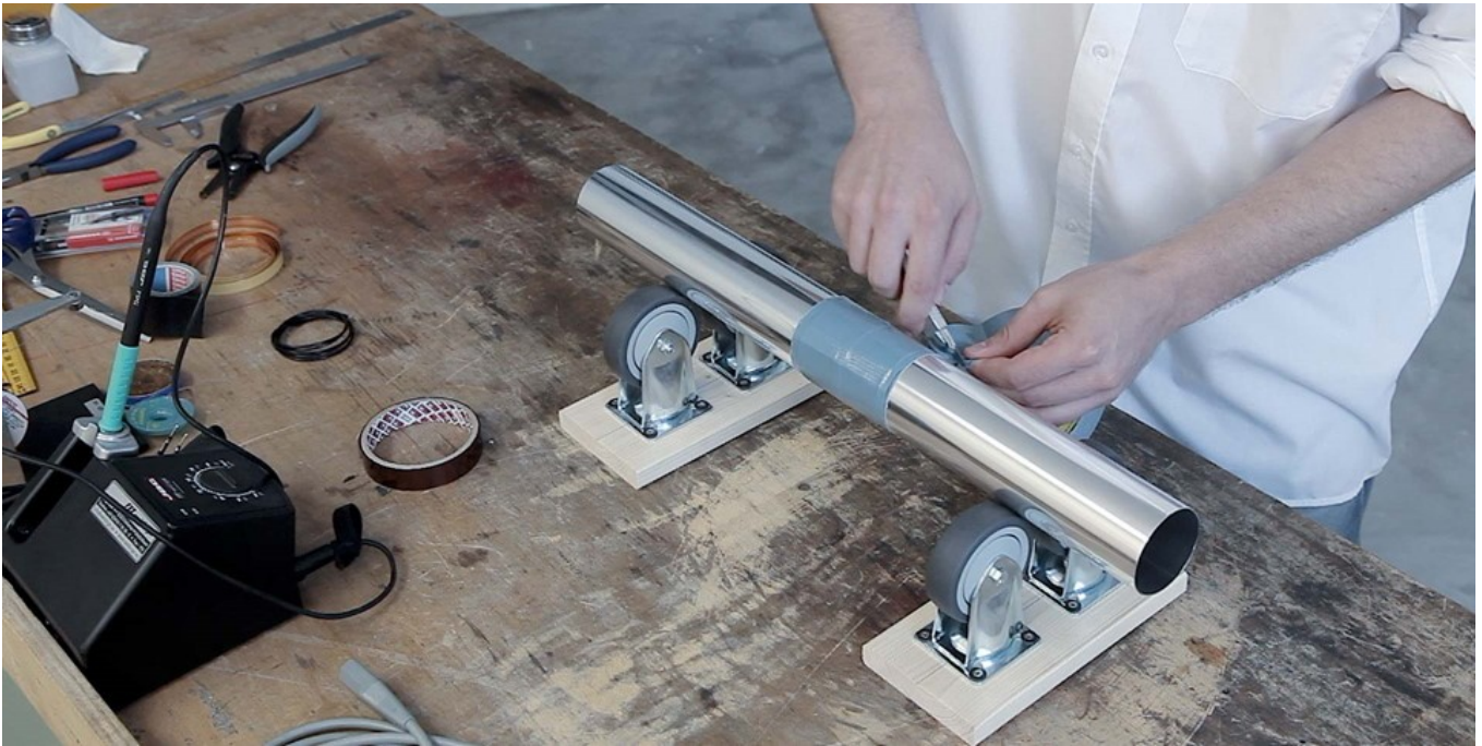
Abb. 29: Anbringen von Isolierband
