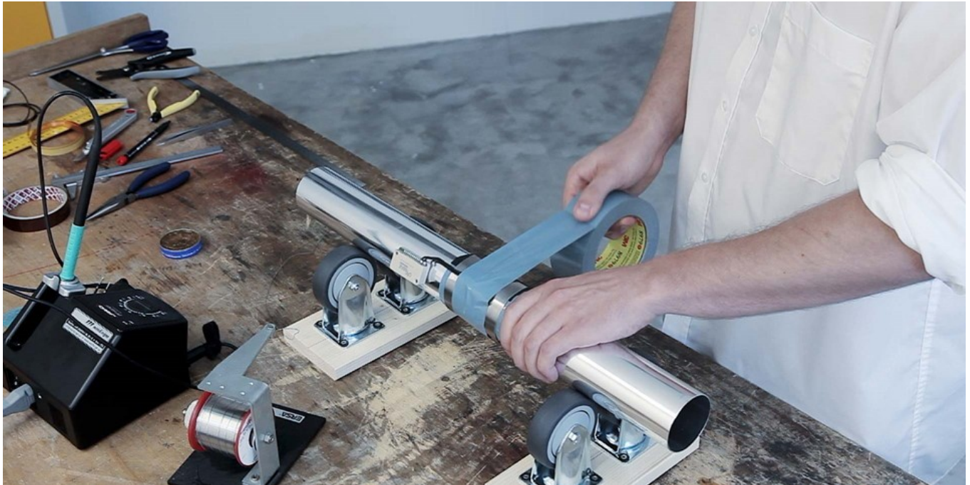
Abb. 42: Graues Klebeband zur Isolierung und zum Schutz anbringen
