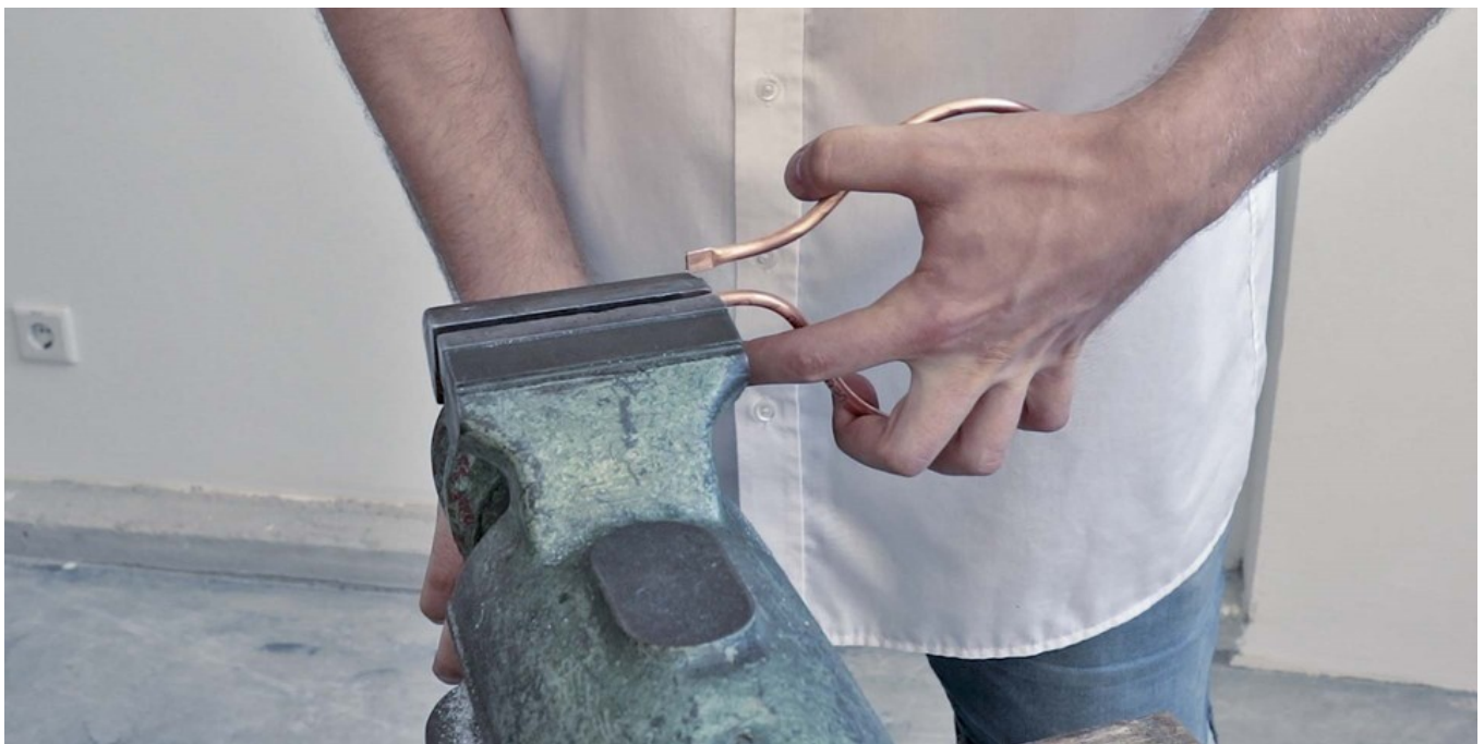
Abb. 48: Das Kupferrohr an beiden Enden zusammenpressen
