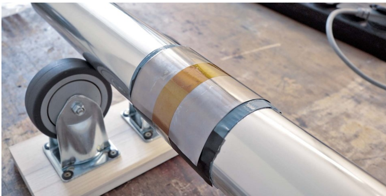
Abb. 34: Nach Anbringen des Kaptonbands
