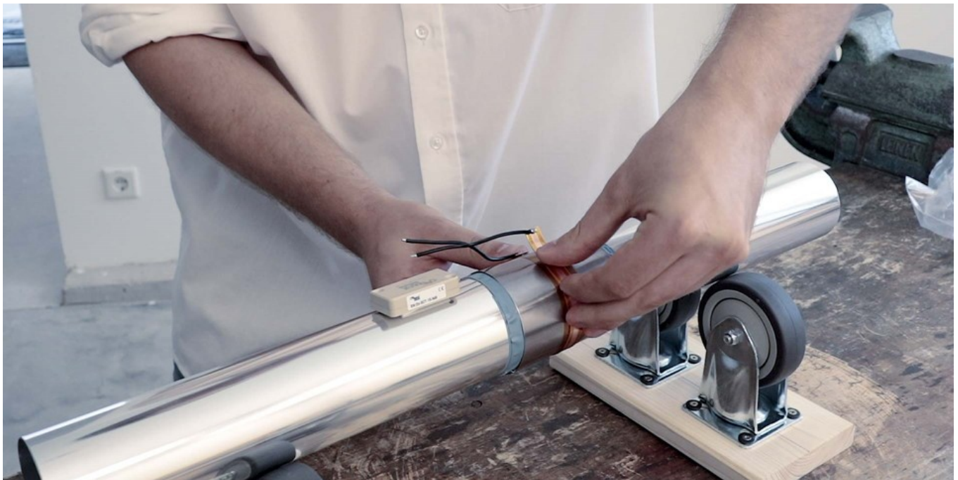
Abb. 39: Montage der Sekundärwicklung
