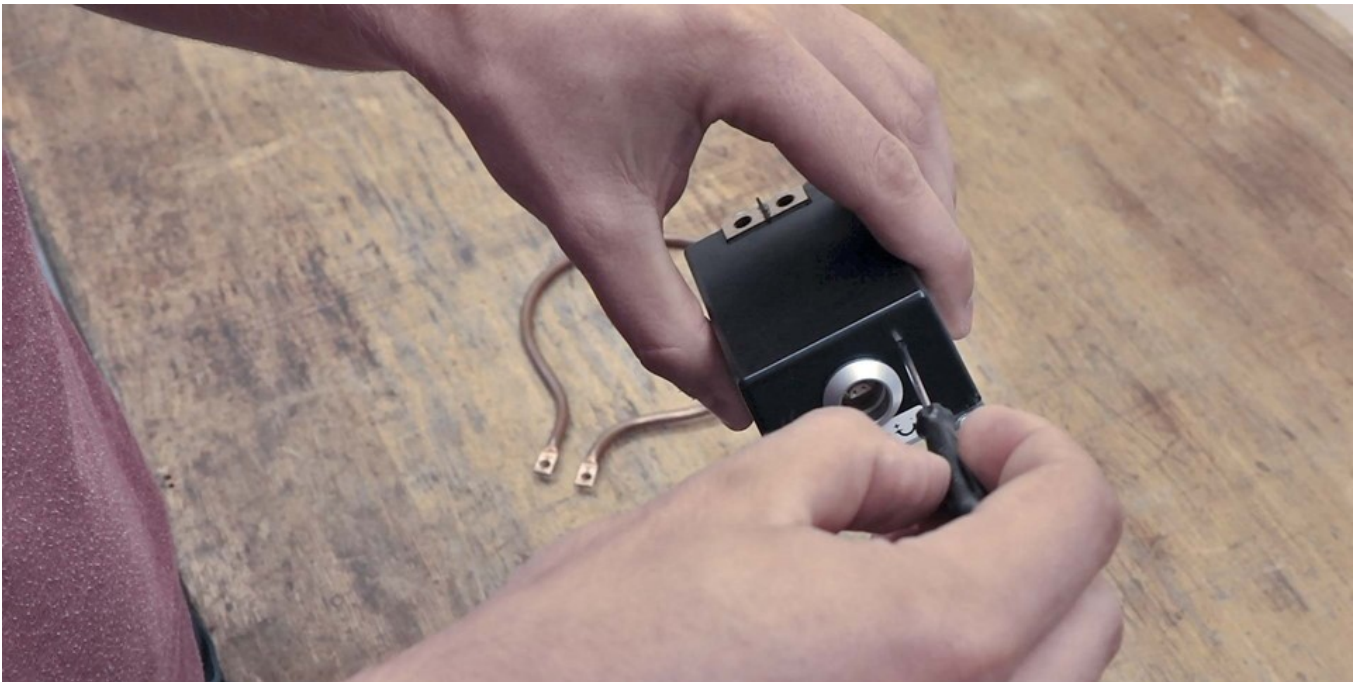
Abb. 53: Spannungsregler in die Minimalstellung bringen
