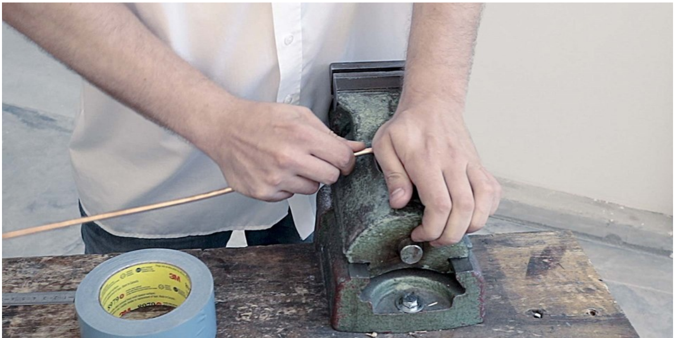
Abb. 46: Die Enden des Kupferdrahts abbiegen
