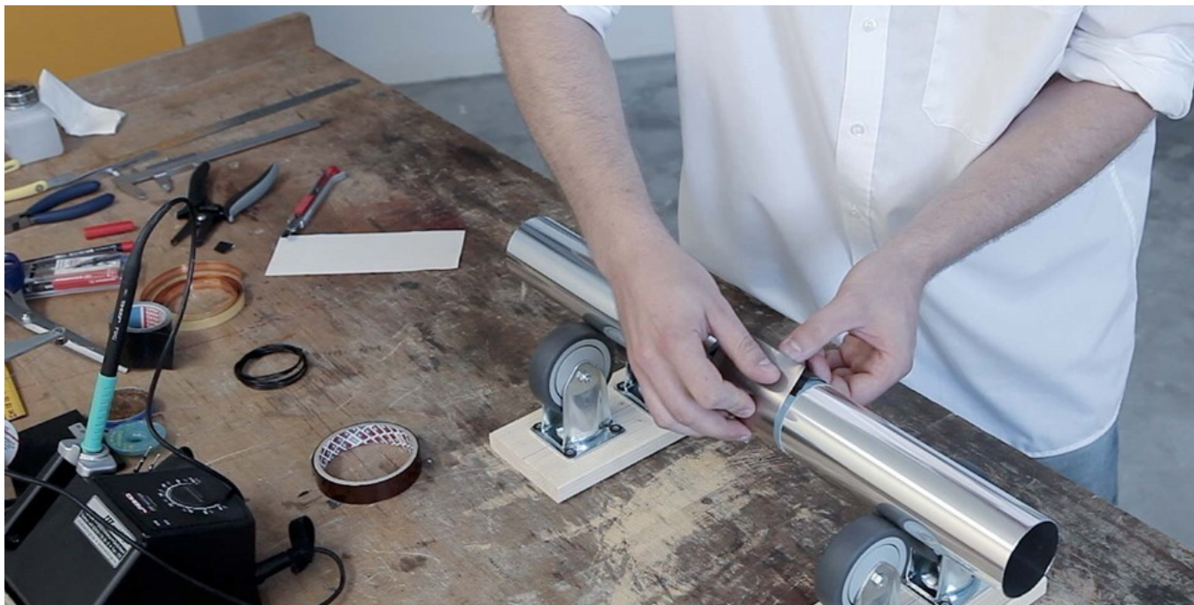
Abb. 27: Erste Mu-Metall-Schicht auf die Welle aufbringen
