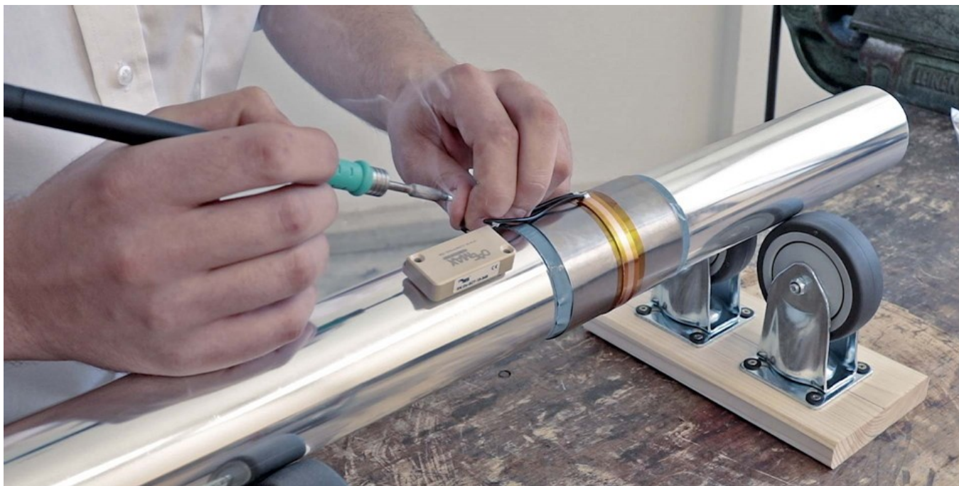
Abb. 40: Verlöten der Drahtenden mit der Sendeeinheit D x -SCT
