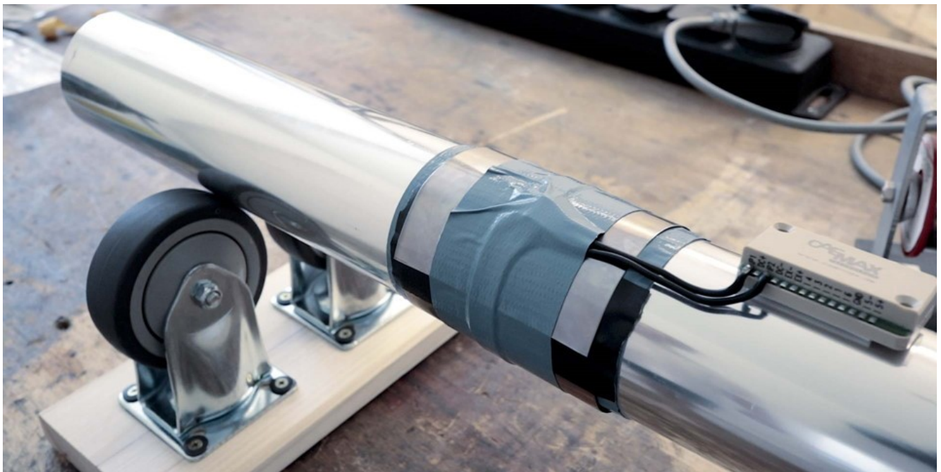
Abb. 43: Die fertig montierte Sekundärwicklung
