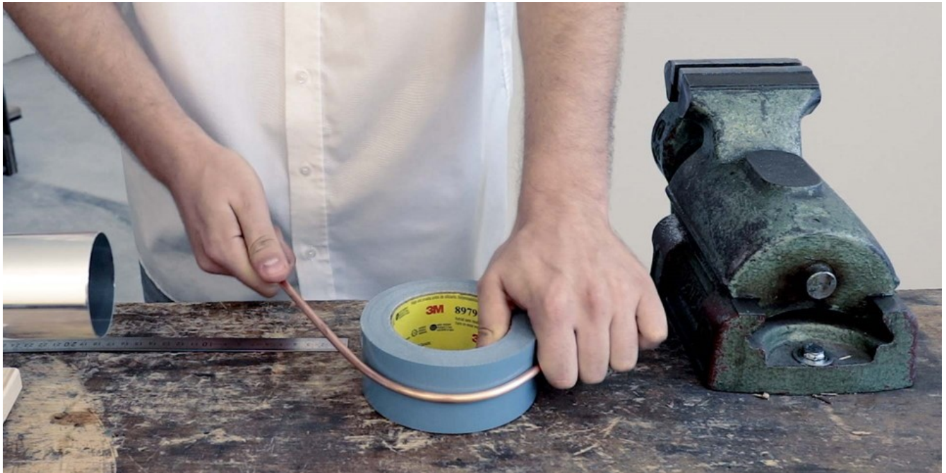
Abb. 47: Den Bogen des Ringstators formen
