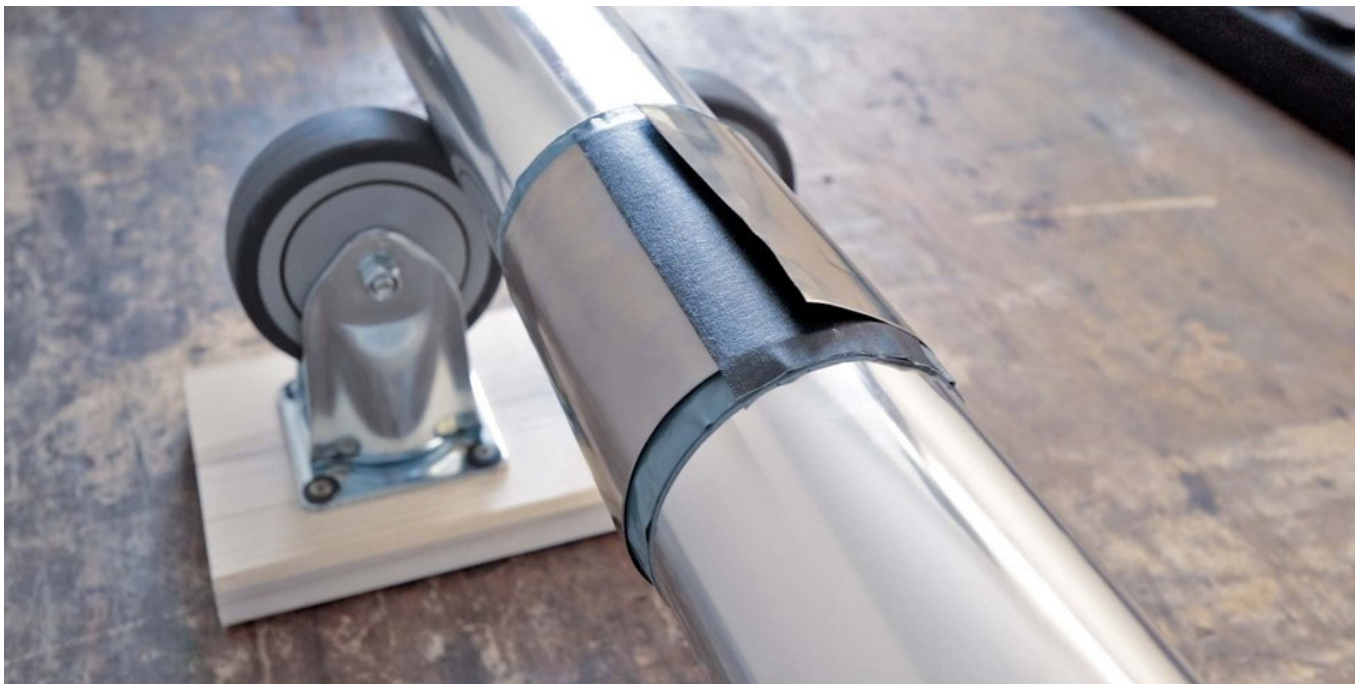
Abb. 32: Nach Anbringen der zweiten Mu-Metall-Schicht
