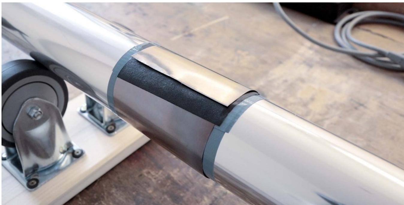
Abb. 28: Nach Anbringen der ersten Mu-Metall-Schicht
