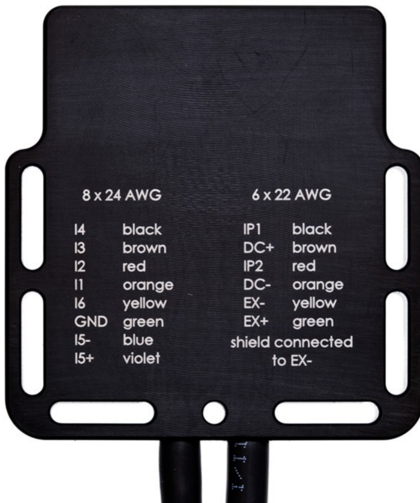
Abb. 9: Dx-SCT mit Anschlusskabel in einem Sondergehäuse: Farbschema
