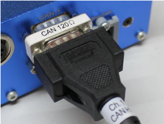
Abb. 58: Eingesteckter CAN-Abschlusswiderstand (120 \Omega )
