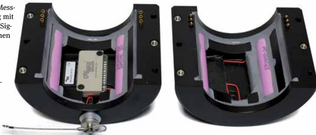
**Bild 3:** Dx-Sendemodul (SCT) mit integriertem Akku in einem Halbschalengehäuse zur Montage an Antriebswellen.
