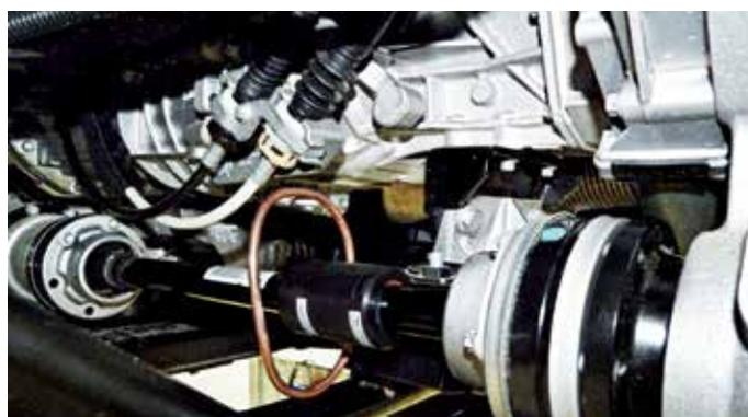
**Bild 4:** Dx-Sendemodul mit induktiver Versorgung an einer Antriebswelle von Oberaigner.
