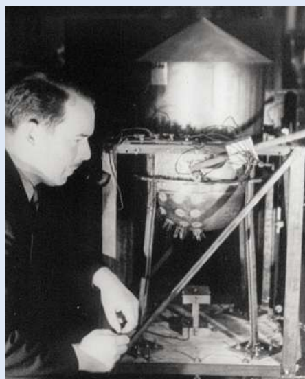
Bild 4: Arthur C. Ruge am Modell eines Wassertanks auf einem Rütteltisch mit den ersten Dehnungsmessstreifen (Untersuchung des Verhaltens bei Erdbeben).
