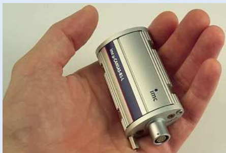
Bild 4: Ein aktueller einkanaliger Miniatur-DMS-Verstärker mit digitaler CAN-Schnittstelle, der dezentral als intelligenter Sensor installierbar ist.
