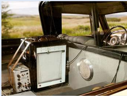
Bild 3: Statt Flachdisplay und SSD kam 1960 ein Papierschreiber zum Einsatz, der nur bedingt rüttelfest und nur zur Aufzeichnung eines einzigen, ausgewählten Kanals geeignet war.
