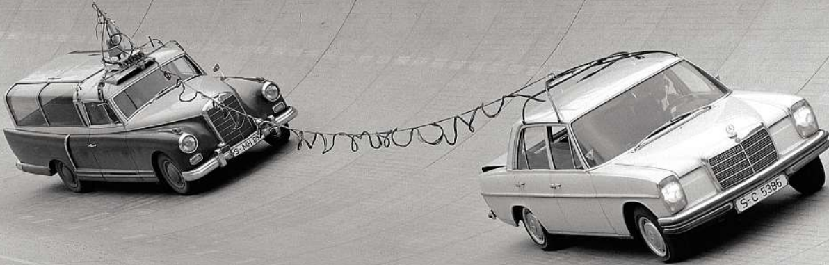
Bild 1: Bei der DMS-Messtechnik im mobilen Fahrversuch 1960 waren das vorausfahrende Testfahrzeug und der Messwagen durch einen Messkabelbaum verbunden.
