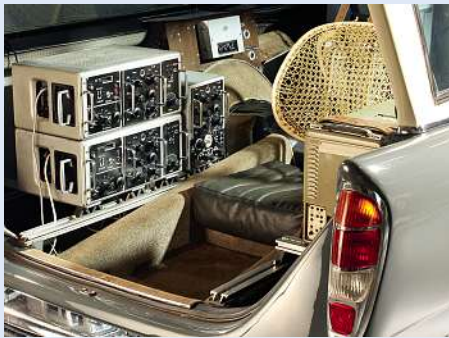
Bild 2: Das mobile Messlabor mit Messverstärkern in Röhrentechnik erfasste gerade einmal vier DMS-Kanäle. Bei heutigen Fahrdynamik-Untersuchungen sind mehrer Hundert Kanäle keine Seltenheit.
