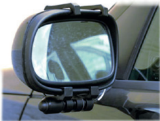
D x -Spiegelantenne zur schnellen Ausrüstung im Fahrversuch
